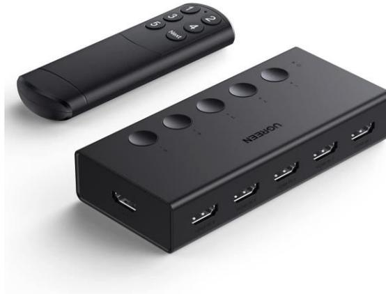
**Este interruptor HDMI 5 en 1 admite la transmisión de video y audio desde 5 dispositivos HDMI a 1 pantalla HDMI. Libérate de enchufar y desenchufar cables HDMI. Con sus 5 indicadores LED, puede saber fácilmente qué puerto está activo desde la luz LED.**
